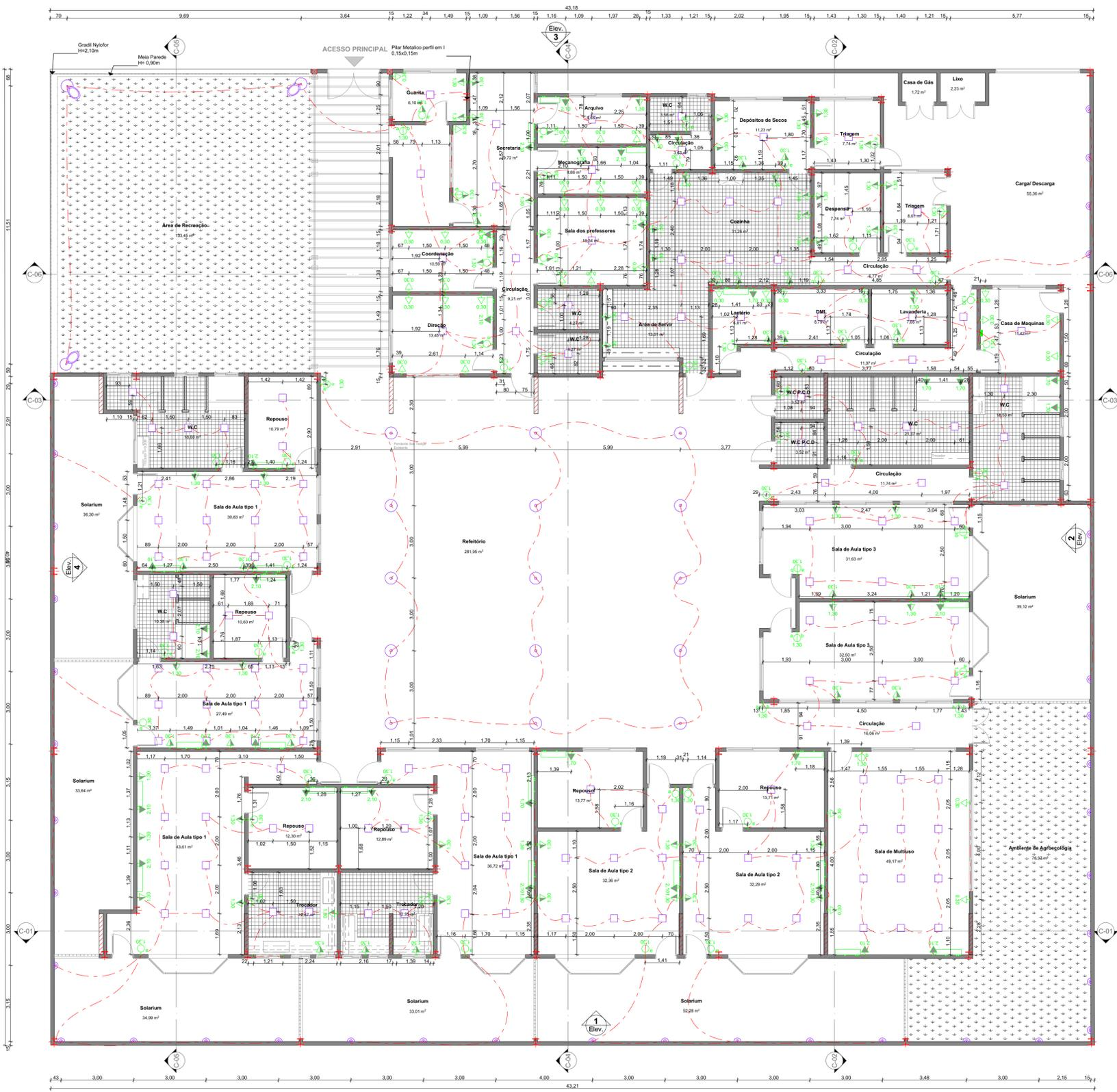
1 Planta de Pontos Elétricos
